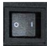
Interruttore di alimentazione principale
